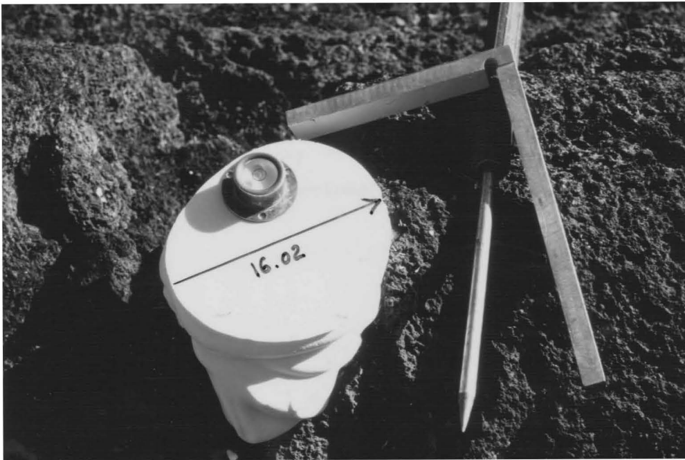
Photo: Prélèvement d'un échantillon paléomagnétique. La flèche indique la direction de l'ombre du soleil à 16h02. Son azimut permet de retrouver la direction du N géographique pour le calcul de la déclinaison magnétique.
