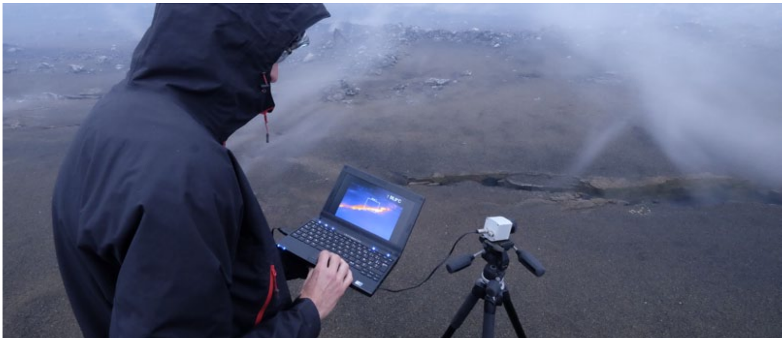
Mesure des dimensions par Pierre-Yves avec un télémètre laser et prise de vue à la caméra thermique pour Raphaël
