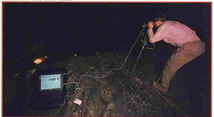
Mesure au pyromètre optique depuis le bord du pit-crater, effectuée de nuit pour atténuer les effets parasites du rayonnement solaire, il faut cependant ajouter environ 25 °C aux valeurs obtenues pour compenser la distance. Données enregistrées sur PC (mesures en continues)
