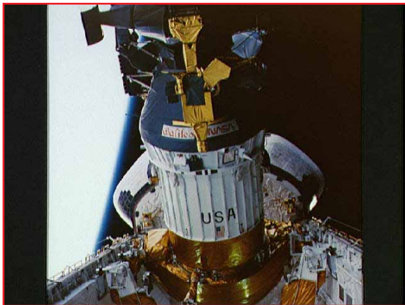
Largage de la sonde Galileo depuis les soutes de la navette Atlantis.
