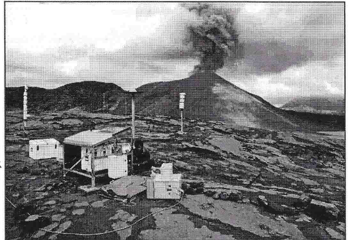
Station de surveillance et enregistrement sismologique momentané (Mexico-Techn.), pt 4 sur la carte ci-contre.
